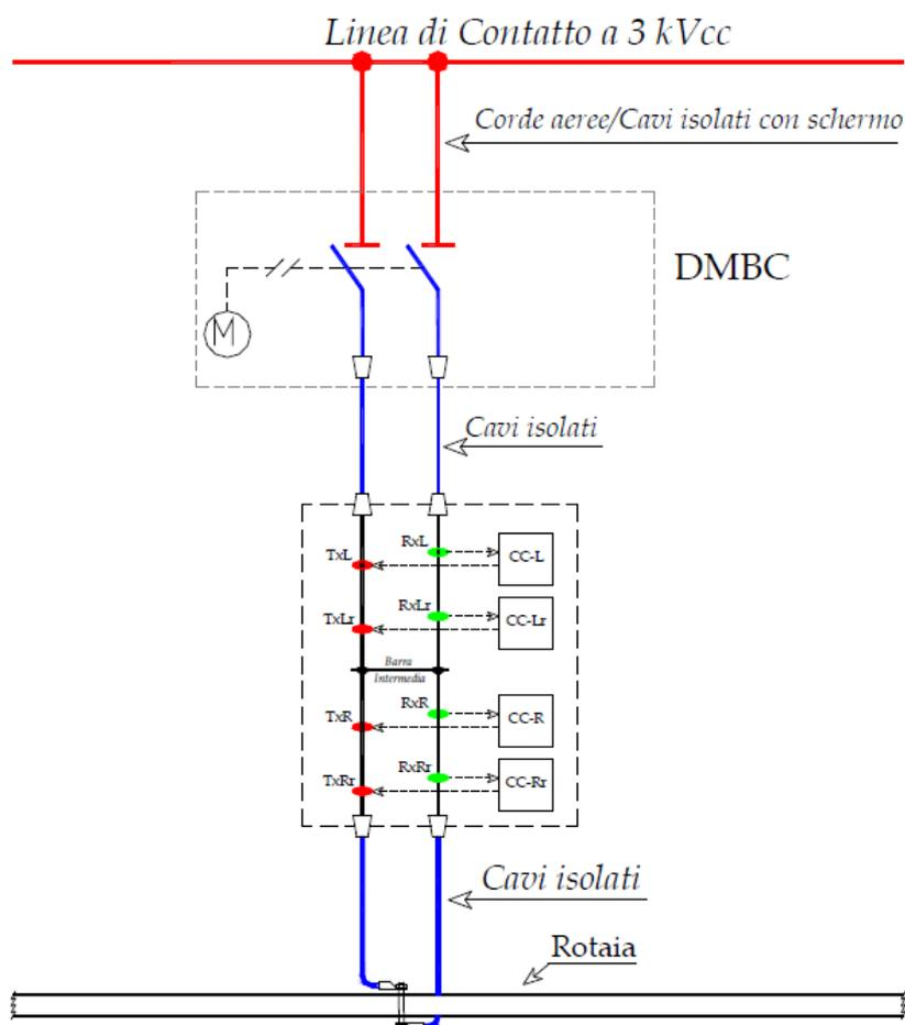
Per consentire il corretto funzionamento del QCC, il DMBC è provvisto di due lame delle medesime caratteristiche. Il DMBC a doppia lama viene collegato alla linea di contatto (LdC) tramite due cavi di pari sezione ed in grado di sostenere l'intera corrente di corto circuito. I punti di collegamento alla linea/feeder devono essere disgiunti in modo che non esista la possibilità di distacco contemporaneo dei cavi dalla linea senza che si interrompa la continuità tra i cavi stessi.
