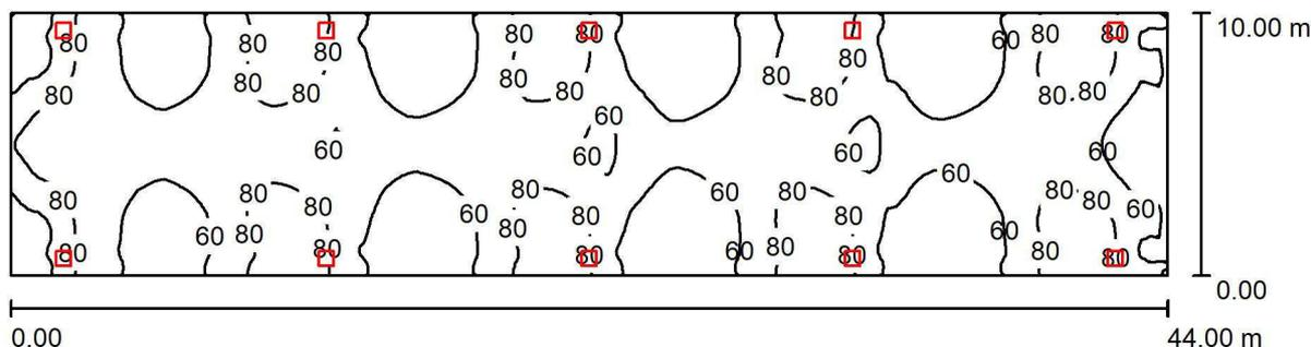
Altezza locale: 4.580 m, Altezza di montaggio: 4.580 m, Fattore di manutenzione: 0.80
