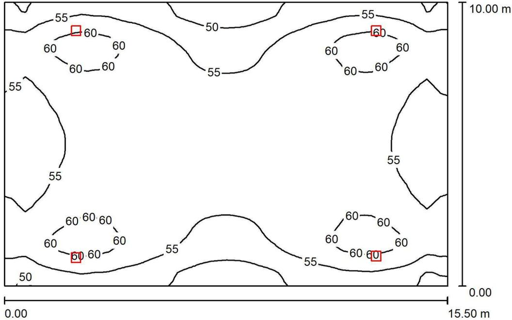
Altezza locale: 5.050 m, Altezza di montaggio: 5.120 m, Fattore di manutenzione: 0.80
