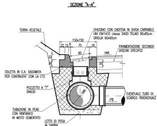
**SEZIONE COLLETTORE TIPO "CT2 DN ( )"**
