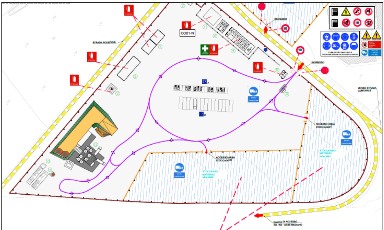
Area cantiere operativo CO 01-N: installazioni, misure di prevenzione e protezione
