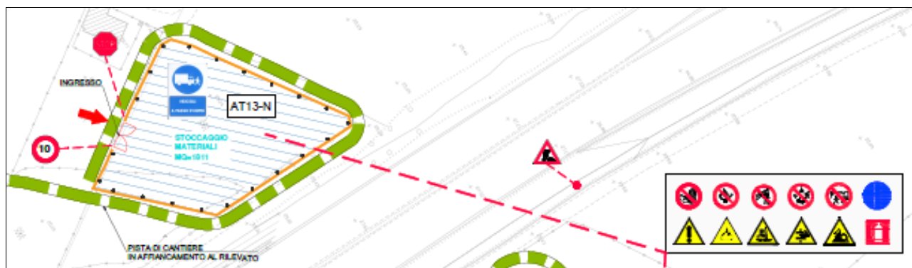
Area tecnica AT 13-N: installazioni, misure di prevenzione e protezione
