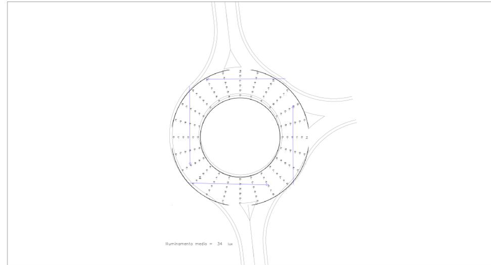
RISULTATI LUX IN ROTATORIA TIPO DIAMETRO EXT. 45 METRI
