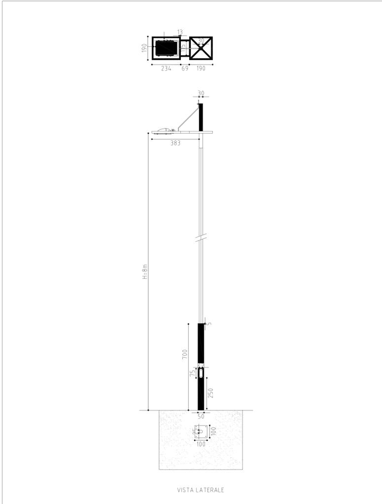
ARMATURA STRADALE PER IL RACCORDO CON ROTATORIE
