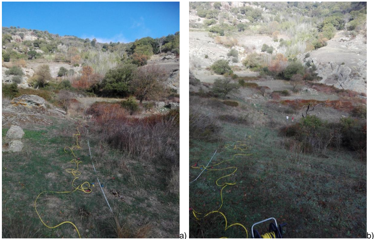
Figura 6 a e b: Particolari illustranti le pendenze in gioco e gli allestimenti di linee sismiche per onde di compressione e di taglio
