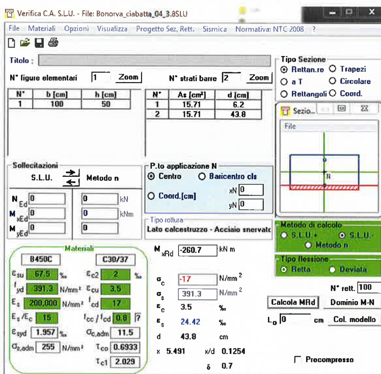
FIGURA 8.39: OUTPUT DEL SOFTWARE "VCA SLU" PER IL CALCOLO DEL MOMENTO RESISTENTE
