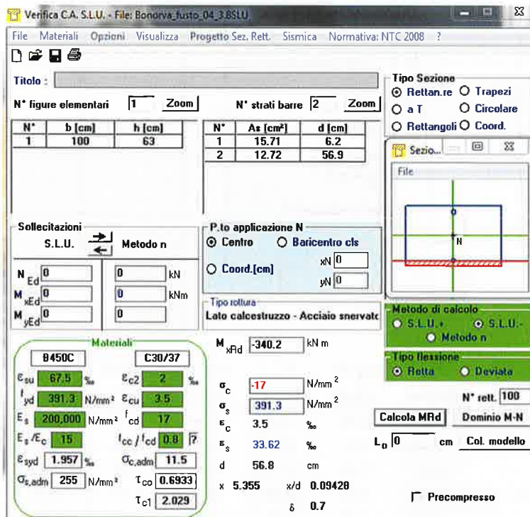
FIGURA 8.35: OUTPUT DEL SOFTWARE "VCA SLU" PER IL CALCOLO DEL MOMENTO RESISTENTE
