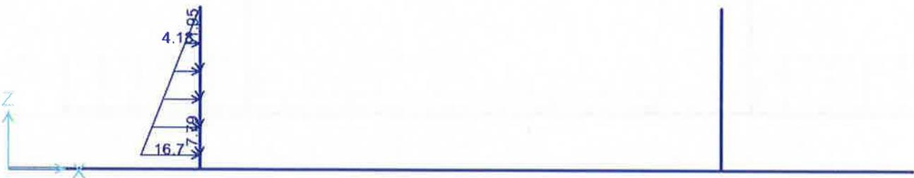
**FIGURA 8-9: SPINTA DEL TERRENO IN FASE SISMICA**
