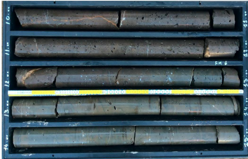
Figura 3. Formazione BST – Sondaggio S4 da 10 m a 15 m
