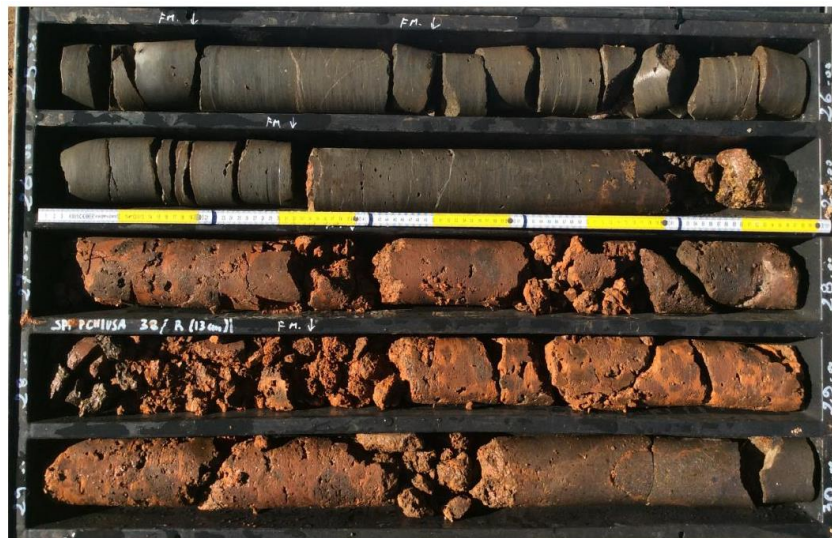
Figura 4. Formazione BST – Sondaggio S4 da 25 m a 30 m
