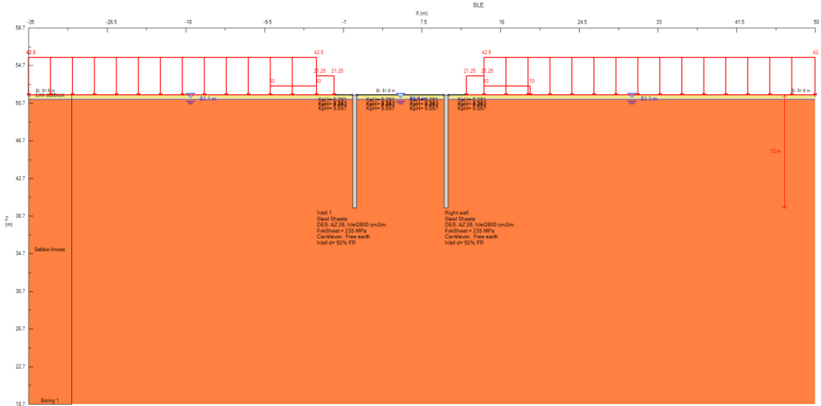
Fig. 20 – Palancolato provvisorio L_{palancola}=12\text{ m} : STEP 0
