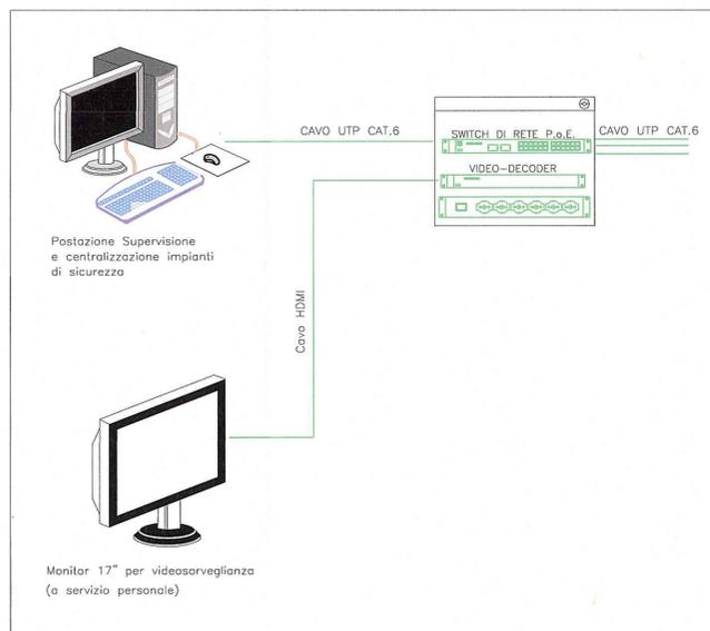
**PARTICOLARE TIPOLOGICO COLLEGAMENTO APPARECCHIATURE**
