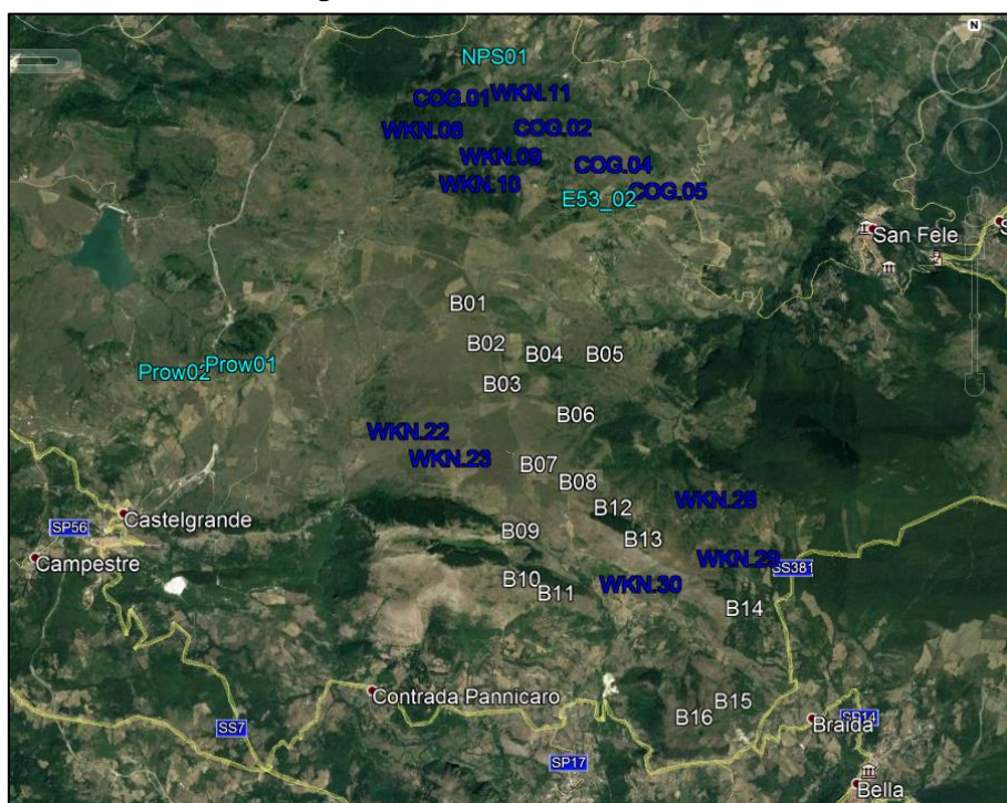
Figura 9: Inquadramento dell'area in oggetto proposto su stralcio di ortofoto planimetrica. Etichette in bianco individuano le turbine di progetto, in ciano gli aerogeneratori già insistenti sul territorio ed in blu le turbine autorizzate.
