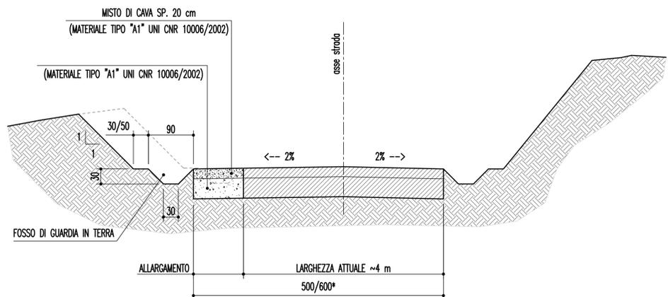
SEZIONE STRADALE TIPICA IN RILEVATO
