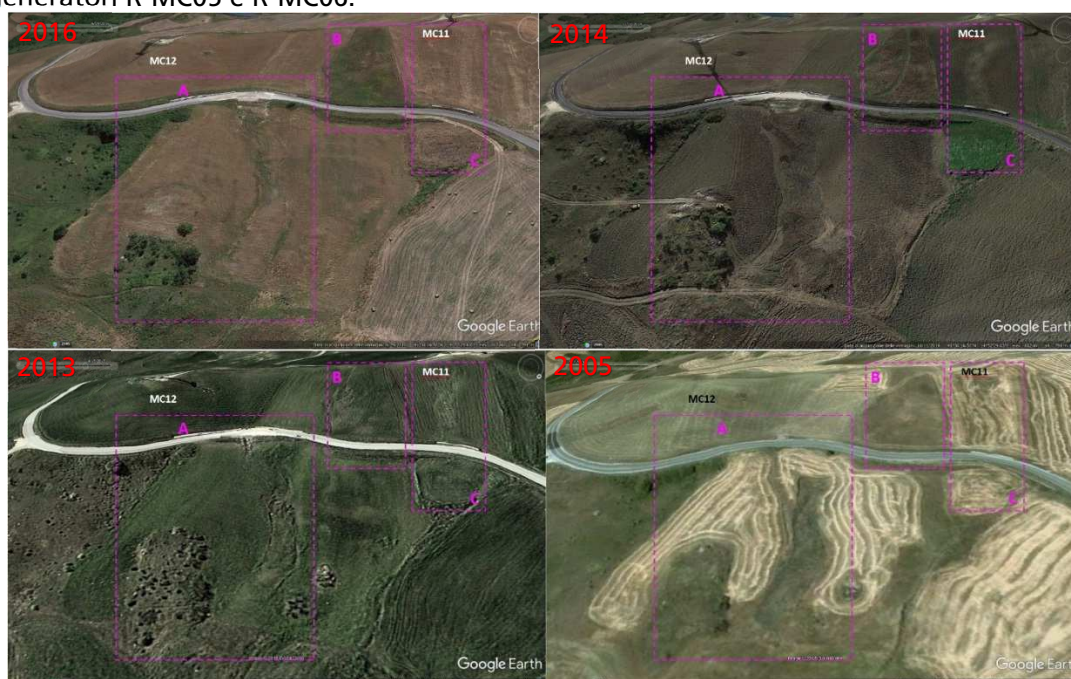
Figura 7.21- Stralci fuori scala delle immagini estratte dal sito di Google Earth Pro del 2016, 2014, 2013 e 2005 inerenti alcuni fenomeni di colata (A, B e C) che già a partire dal 2005 hanno interessato i pendii a NW del sito prescelto per R-MC05. Si può notare come tali fenomeni abbiano più volte lesionato la sede stradale della SS212, senza però mai espandersi lateralmente e/o retrocedere andando ad intaccare le zone d'imposta ipotizzate per gli aerogeneratori R-MC05 e R-MC06.
