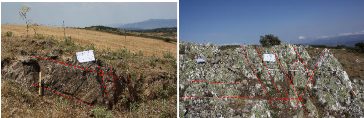
Figura 6.4 - Stazioni di rilievo geomeccanico G01 e G02 rispettivamente in località Sas Tennias e M.te Saraloi. Sotto le rispettive proiezioni stereografiche dei piani di frattura
