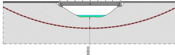
**INTERSEZIONI CAVIDOTTI CON RETE IDROGRAFICA : SEZIONE TIPO ATTRAVERSAMENTO TRASVERSALE CON TECNICA T.O.C.**
