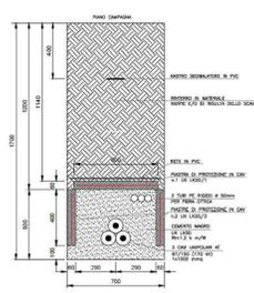
**INTERSEZIONI CAVIDOTTI CON TOMBINI STRADALI : SEZIONE TIPO ATTRAVERSAMENTO**
