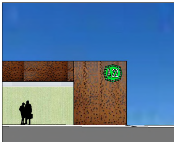
Fig. 5.8 – Particolare Veletta e Portale in Acciaio Corten
