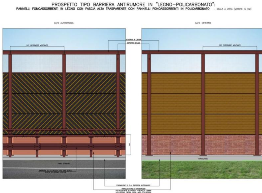
Figura III.12-Prospetto di barriera antirumore in legno – policarbonato
