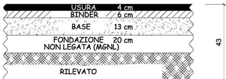
Figura 4 – Sovrastruttura nuove pavimentazioni (TIPO 2)
