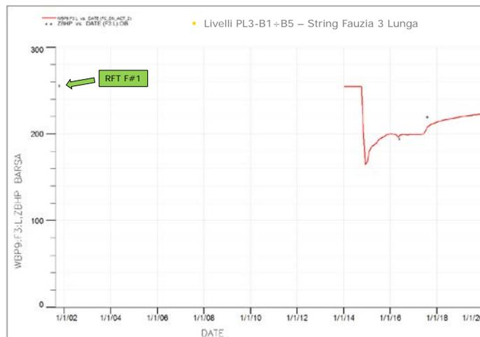
Figura 5 – Campo di Fauzia: dati di pressione (da RFT) vs. modello *Eclipse* 2017
