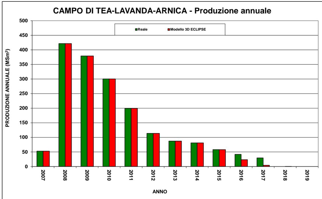
Figura 5b – Campo di TLA: tabella e grafico di produzione vs. modello *Eclipse* 2015
