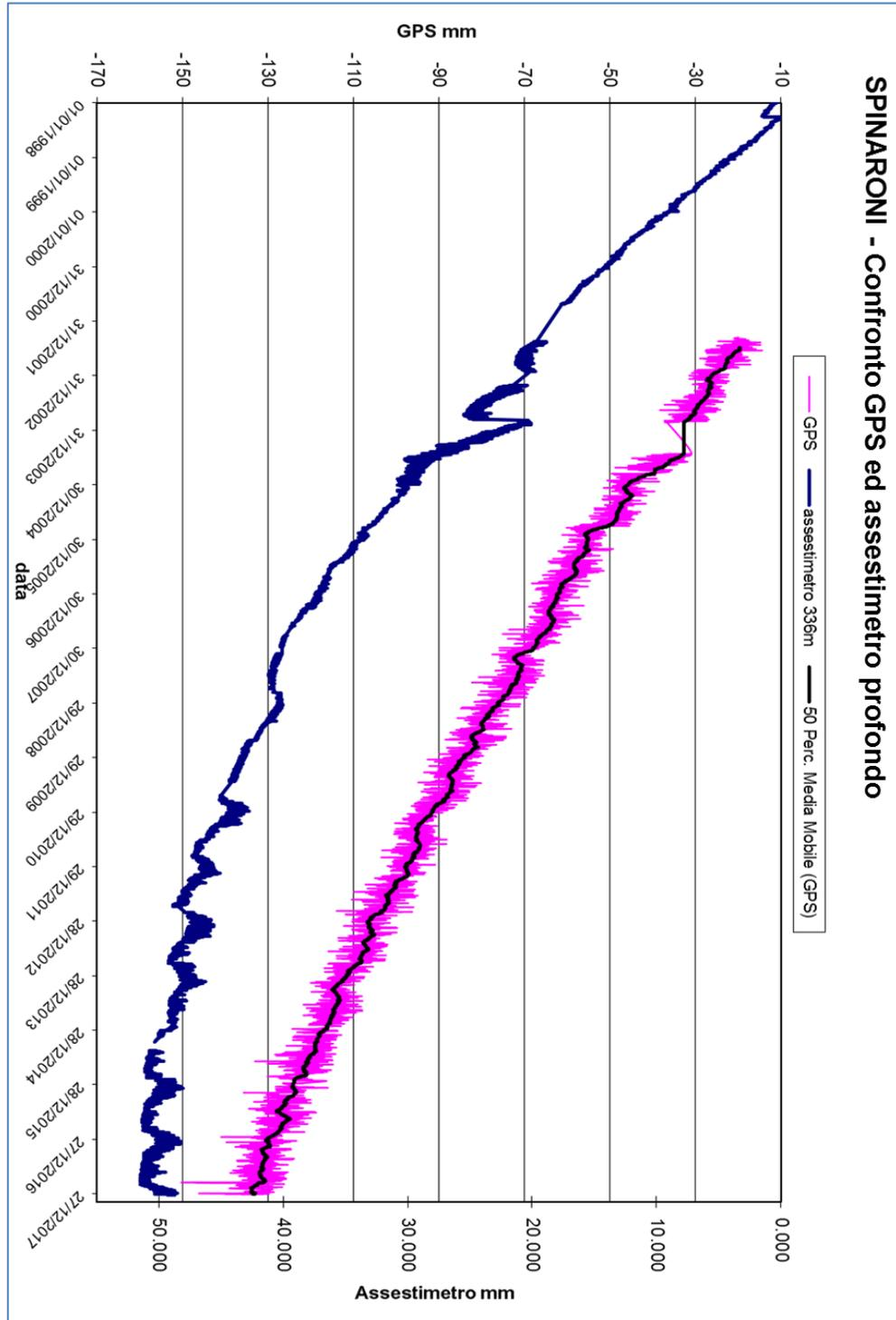
**Figura 10B - Confronto fra misure da CGPS vs. misure di compattazione (ssesttimetro della stazione EPSU di Spinaroni)**
