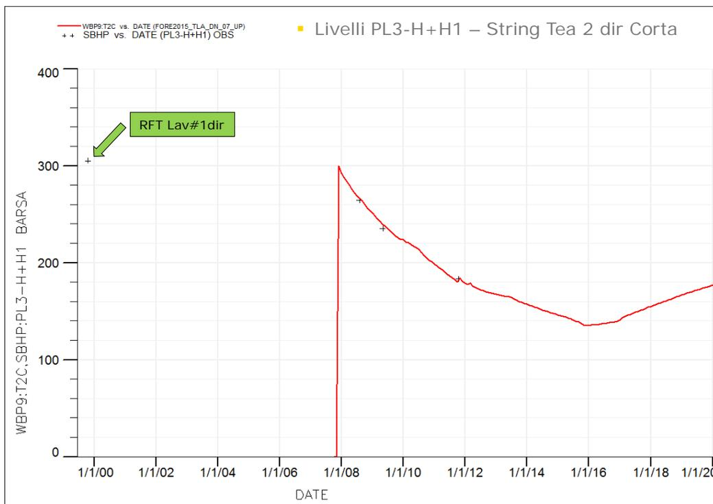
Figura 8 – Campo di TLA: confronto tra dati di pressione da profili statici e modello *Eclipse* 2015 (livello PL3-H-H1)
