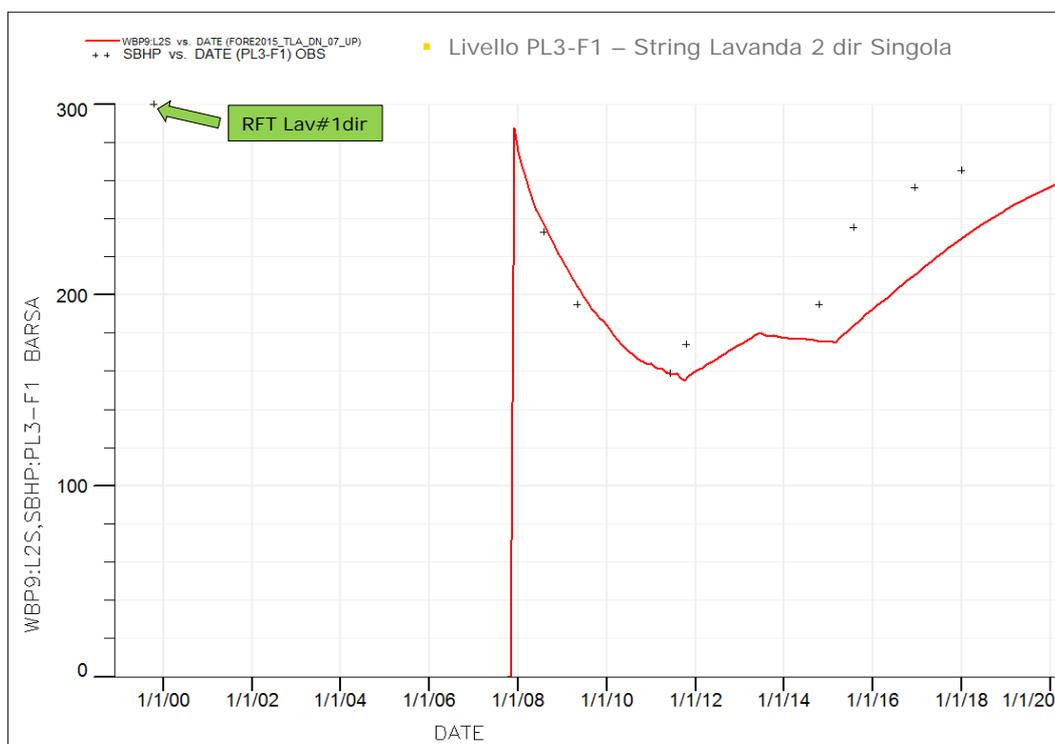
Figura 9 – Campo di TLA: confronto tra dati di pressione da profili statici e modello *Eclipse* 2015 (livello PL3-F1)
