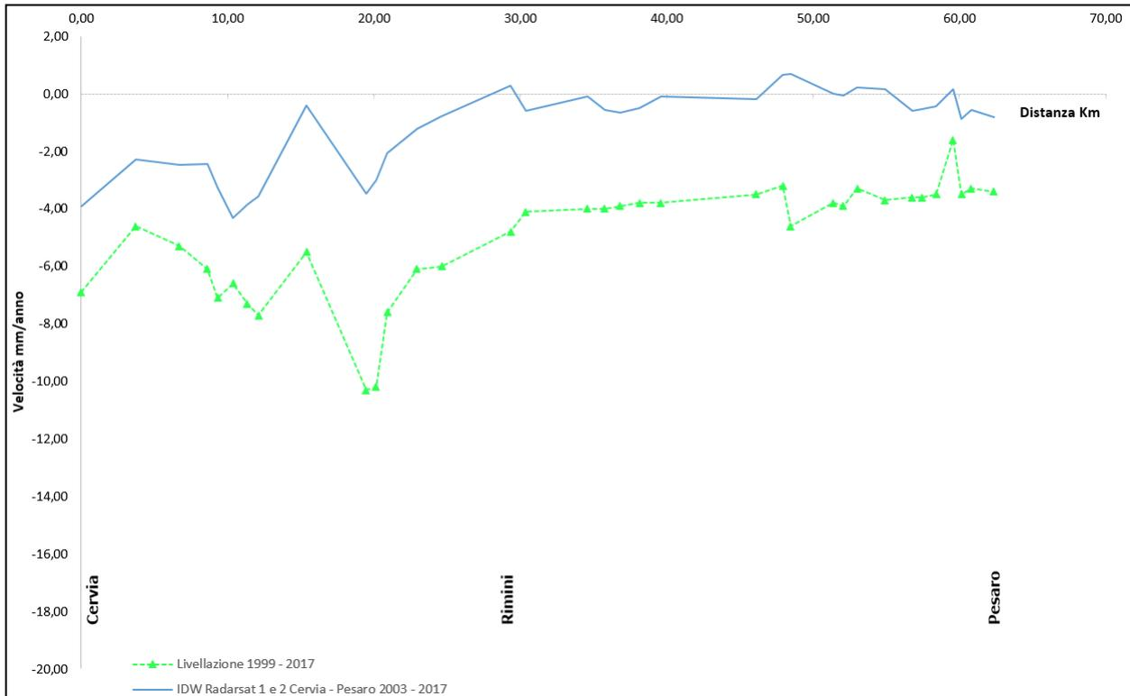
**Fig. 7A – Dettaglio del grafico di confronto tra il database Radarsat 1-2 per il periodo 2003-2017 e le livellazioni del periodo 1999-2017, lungo il tratto Cervia – Pesaro. Non si notano delle anomalie, i due metodi descrivono lo stesso andamento**
