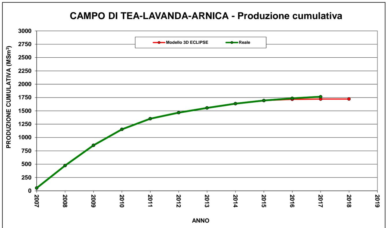
Figura 4a – Campo di TLA: tabella e grafico di produzione vs. modello *Eclipse* 2015
