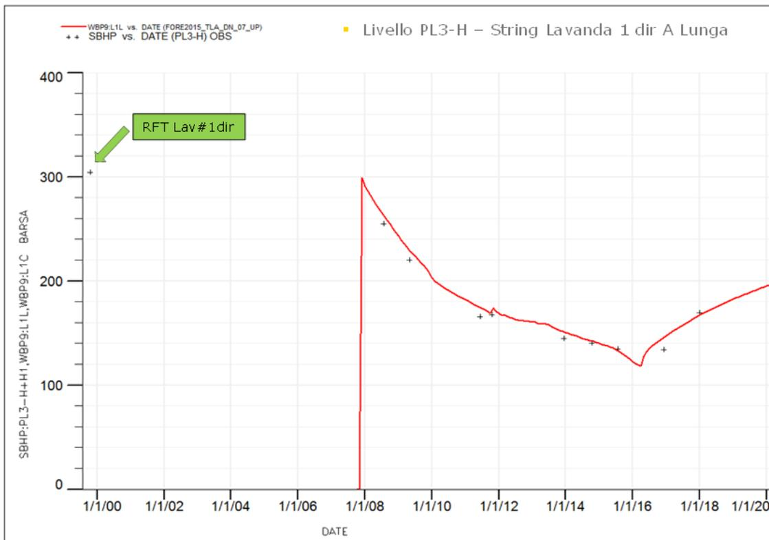
Figura 7 – Campo di TLA: confronto tra dati di pressione da profili statici e modello *Eclipse* 2015 (livello PL3-H)
