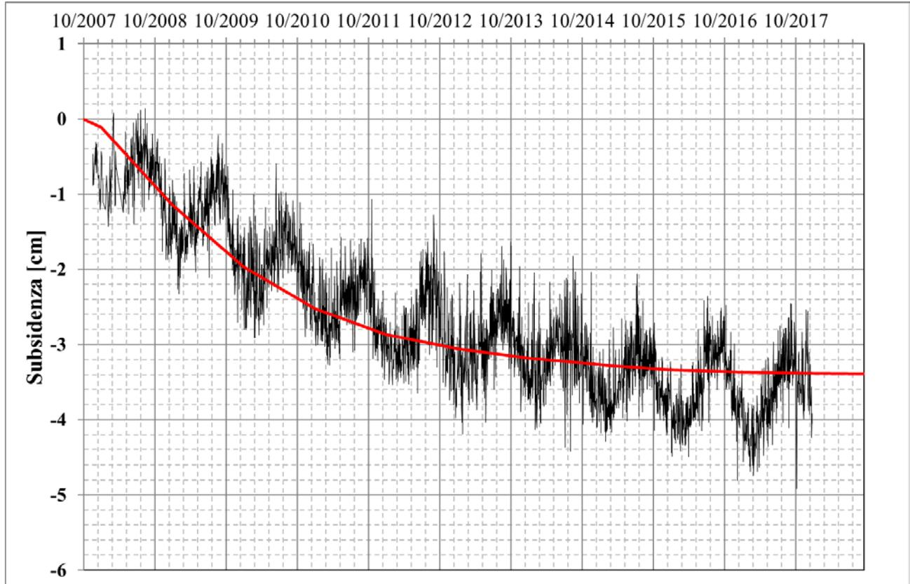
Figura 14 – Campo di TLA: confronto tra spostamento simulato (linea nera) e spostamento misurato (linea rossa), in corrispondenza della stazione CGPS di Tea
