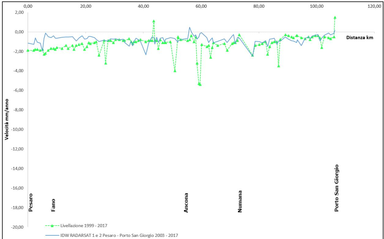
**Fig. 9A - Dettaglio del grafico di confronto tra il database Radarsat 1-2 per il periodo 2003-2017 e le livellazioni del periodo 1999-2017, lungo il tratto Pesaro – Porto San Giorgio. Non si notano delle anomalie, i due metodi descrivono lo stesso andamento**
