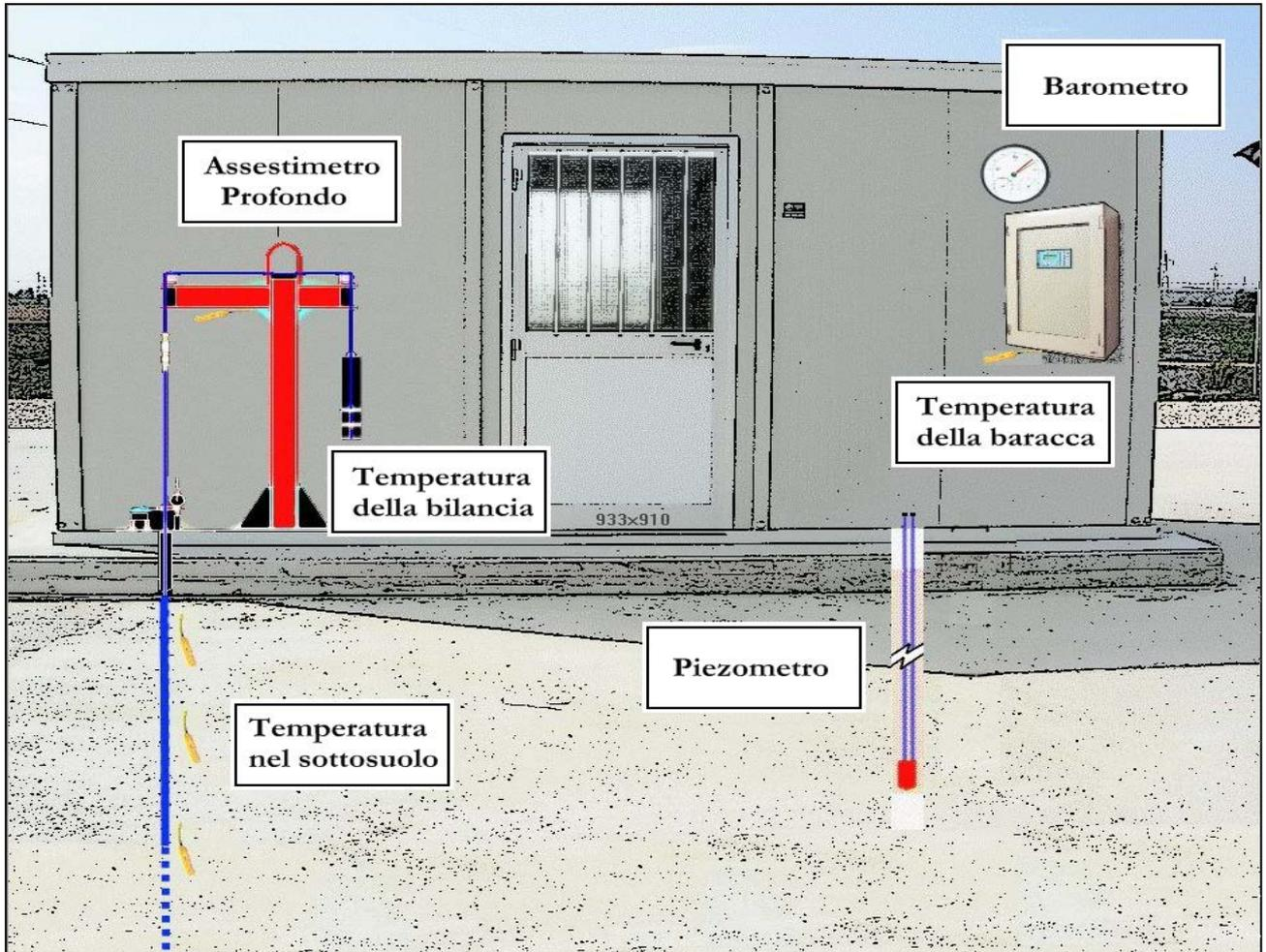
Figura 2B - Rappresentazione schematica di una stazione EPSU
