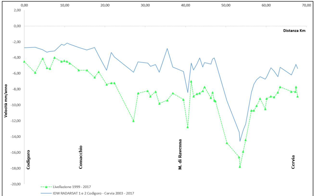
**Fig. 5A - Dettaglio del grafico di confronto tra il database Radarsat 1-2 per il periodo 2003-2017 e le livellazioni del periodo 1999-2017, lungo il tratto Codigoro – Cervia. Non si notano delle anomalie, i due metodi descrivono lo stesso andamento**
