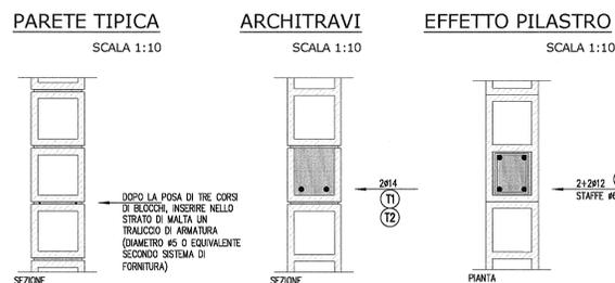
N.B. PREVEDERE SEMPRE UN SISTEMA DI FISSAGGIO DELLE PARETI AD OGNI INTERFACCIA CON PILASTRI IN CEMENTO ARMATO, TRAMITE PROFILI METALLICI SAGOMATI (ZANCHE) COMPATIBILI CON IL SISTEMA DI MURATURA IN BLOCCHI SELEZIONATO PER LA FORNITURA.
