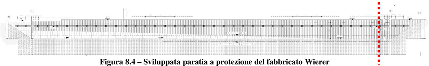
**Figura 8.4 – Sviluppata paratia a protezione del fabbricato Wierer**
