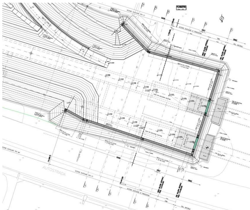
Figura 4.2 – Planimetria di scavo imbocco lato Milano galleria artificiale Lonato
