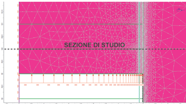
FASE 1: Il fronte di scavo si trova ad 1 m dalla sezione di studio
