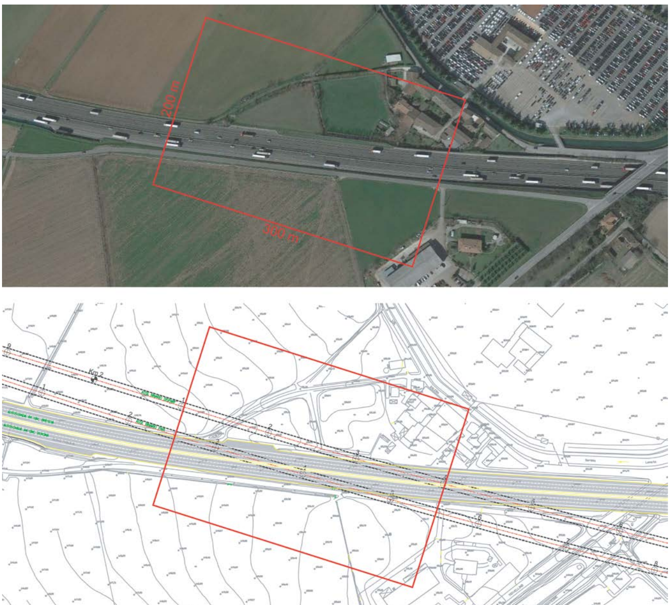
Figura 8.1 – Fotografia aerea (sopra) e planimetria (sotto) dell'area di interferenza tra la galleria Lonato e l'Autostrada A4. Il rettangolo rosso rappresenta l'estensione in pianta del modello di calcolo tridimensionale.
