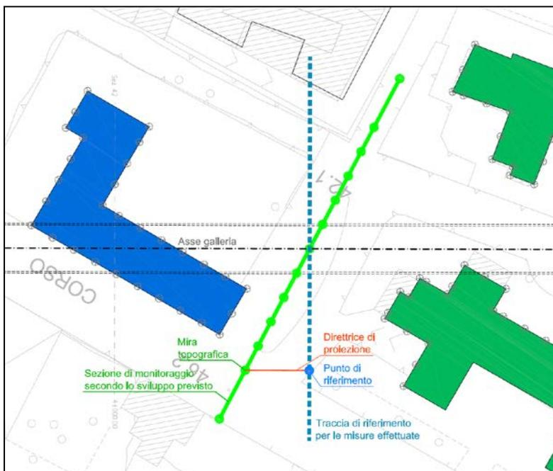
Figura 8-5: Proiezione delle misure sulla traccia di riferimento delle letture
