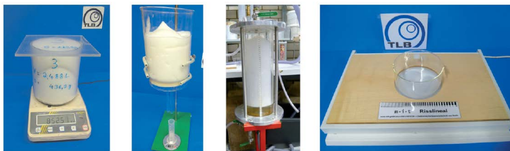
Figura 8.7 – Prove di laboratorio per la valutazione della qualità degli agenti condizionanti, con particolare riferimento al comportamento delle schiume, del loro drenaggio, compressibilità e dimensione delle bolle d'aria.
