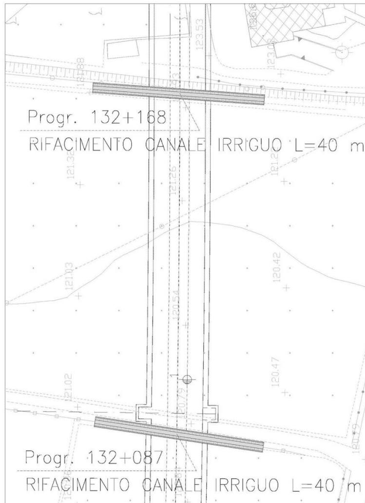
**Figura 8-4: Interferenze alle Pk 142+087 e Pk Pk 142+168 con i canali irrigui agricoli.**
