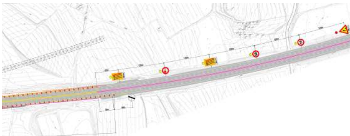
Segnalazione temporanea nelle zone di approccio all'area di cantiere da Ovest e da Est
