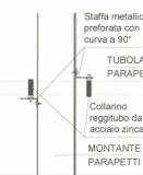
● = Doppio collegamento tra tubolare e montante mediante collarino reggibulo da 2" in acciaio zincato e staffa metallica preforata con curva a 90°
