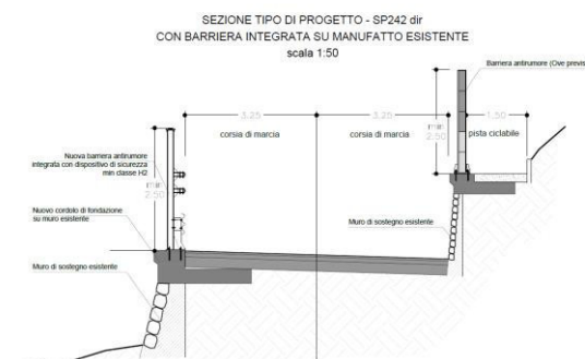
Figura 16 – Sezione tipo Barriera integrata su manufatto esistente
