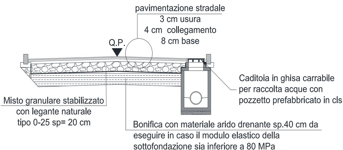
Figura 2 Pavimentazione per Strada di Cantiere Fase Finale
