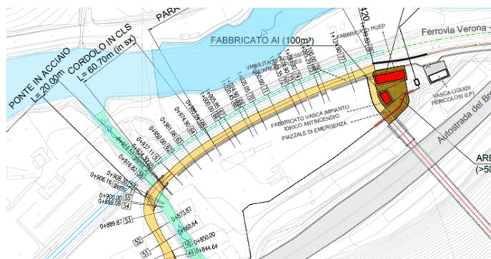
Analogamente a quanto avviene per l'andamento planimetrico, anche altimetricamente l'asse stradale coincide, per i primi 800 m, con quello della strada esistente, mentre per il restante tratto, si è tenuto conto dei vincoli e dell'andamento della zona in cui va effettuato l'intervento.
