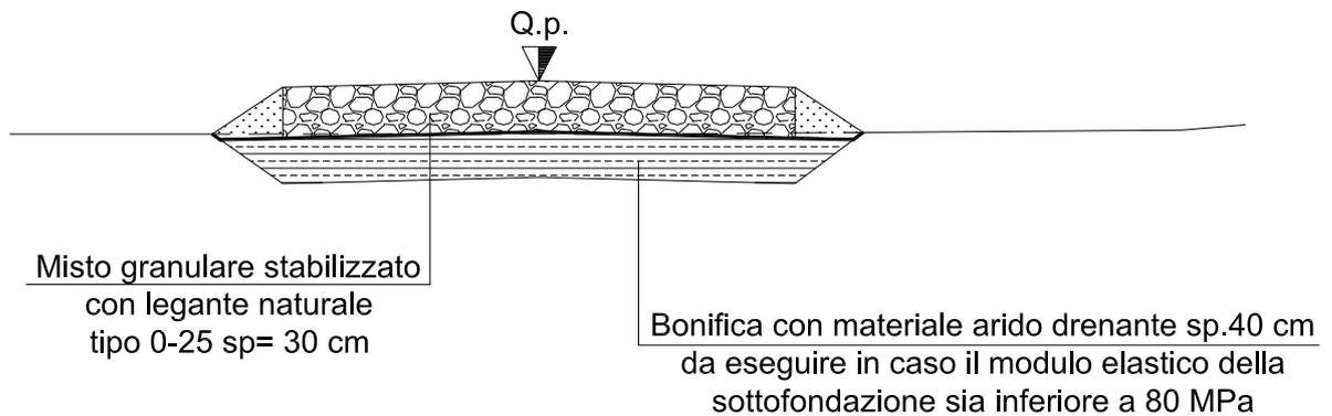
Figura 4 Pavimentazione per Strada Locale Sterrata
