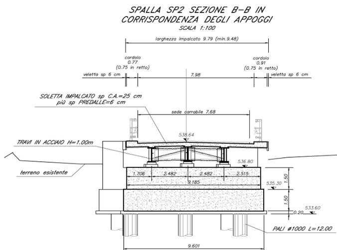
Figura 12 – Sezione impalcato - Spalla SP2
