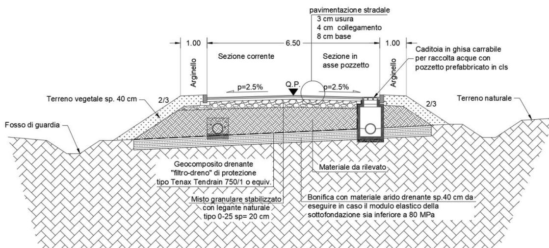
Figura 20 - Sezione Tipo Strada Accesso Cantiere Forch
