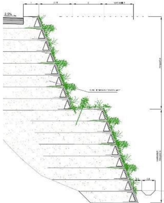
Figura 15 – Sezione muro in terra rinforzata
