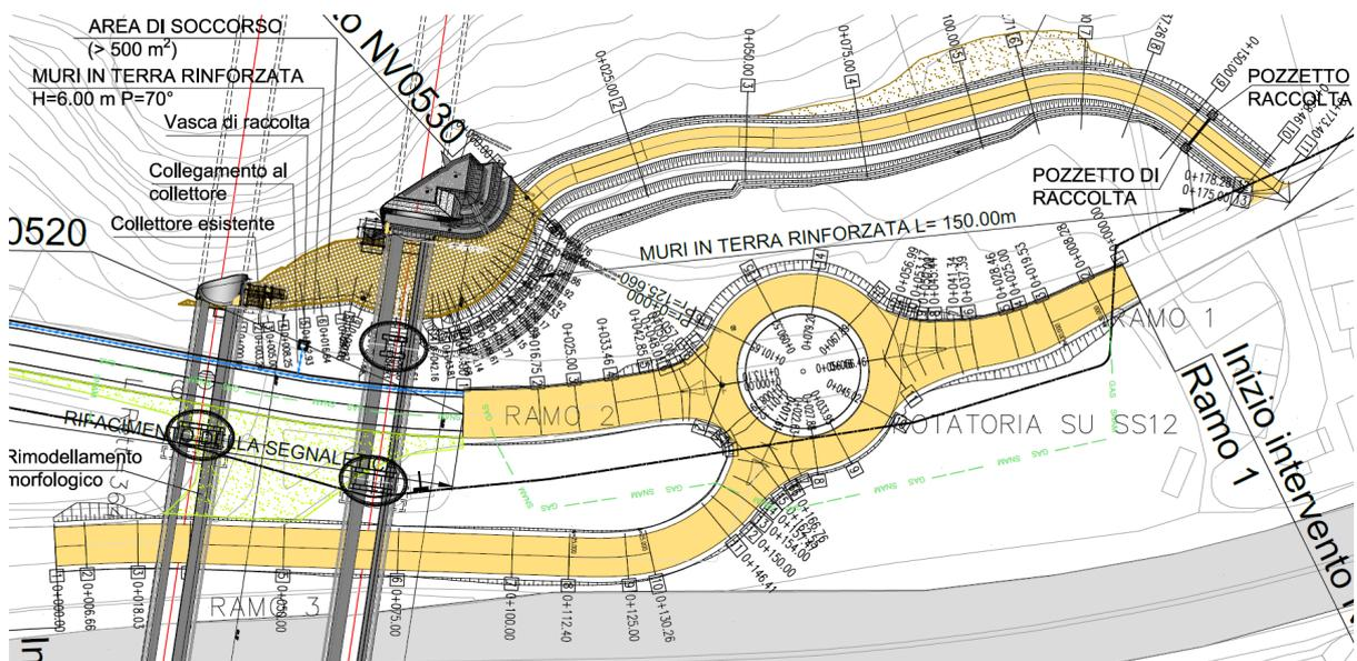
Figura 13 – Planimetria di progetto NV053
