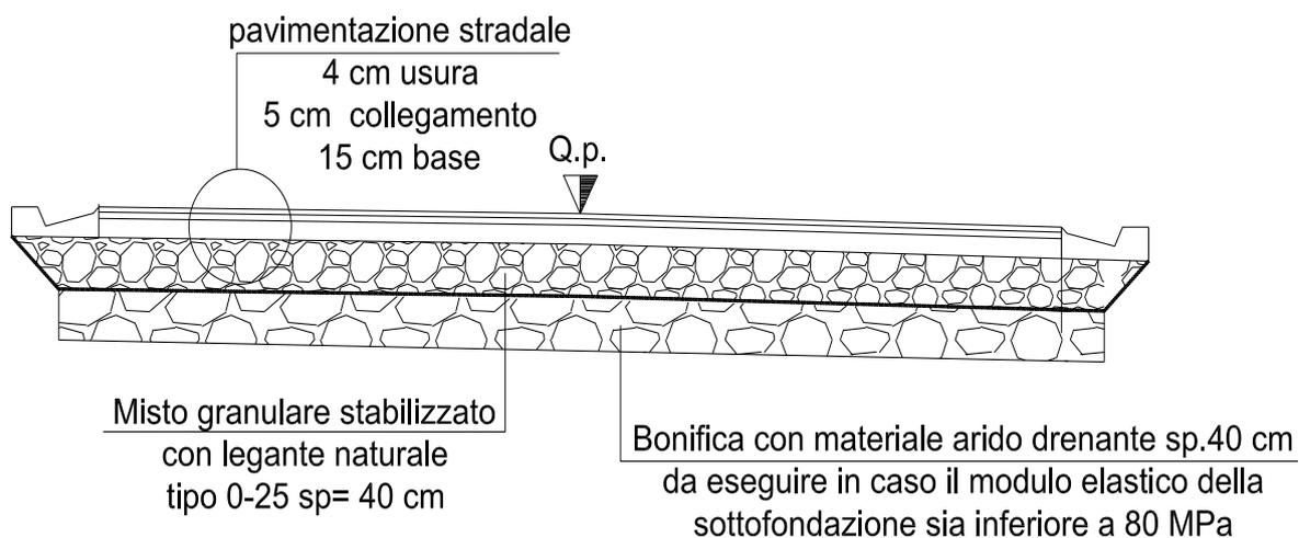
Figura 1 Pavimentazione per Strada Statale F2
