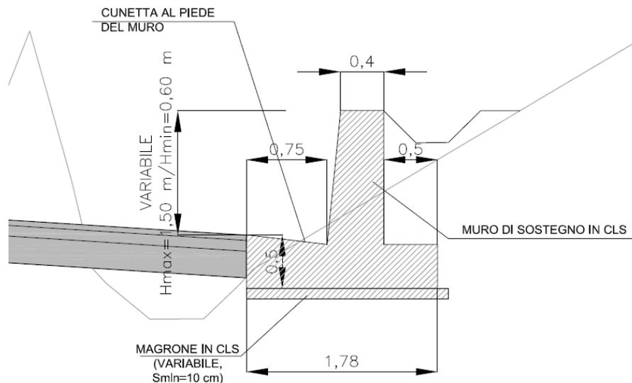
Figura 10 – Sezione muro di sostegno
