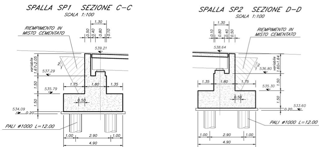
Figura 14 – Sezioni spalle
