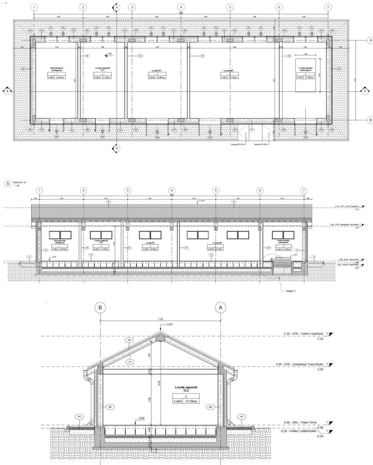
Figura 26 – Pianta e sezioni del fabbricato PGEP di Funes
