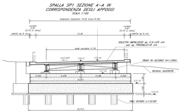
Figura 12 – Sezione impalcato - Spalla SP1
