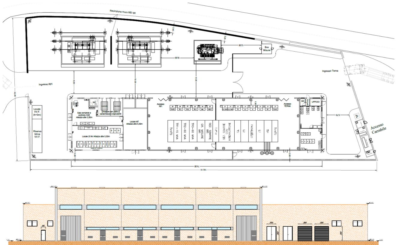
Figura 23 – Pianta e prospetto Fabbricati SSE Ponte Gardena
