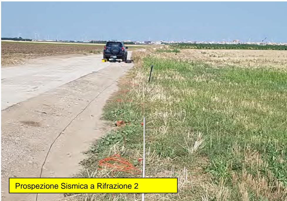
Prospezione Sismica a Rifrazione 2
