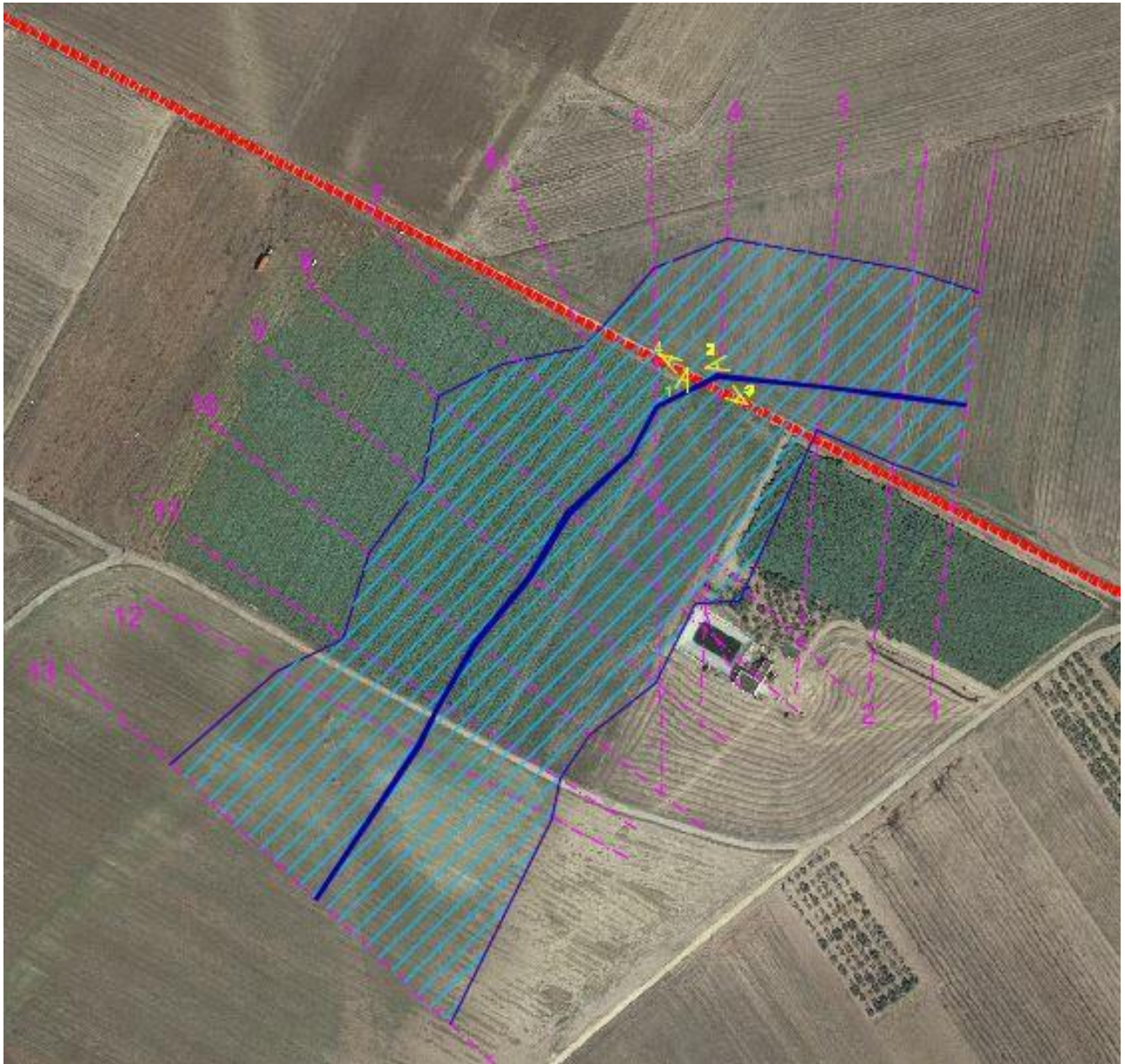
Fig. 4) Planimetria del tratto del canale 2 analizzato con l'indicazione delle sezioni, opere presenti ed in progetto e punti di scatto foto. Per la legenda dei simboli utilizzati si rimanda all'allegato grafico del presente studio.
