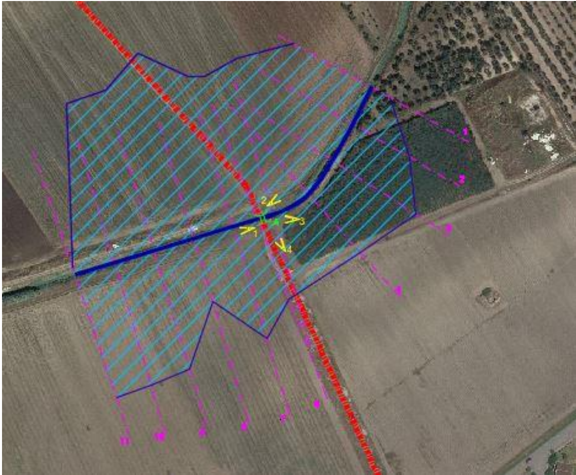
Fig. 6) Planimetria del tratto del canale 3/Marana la Pidocchiosa analizzato con l'indicazione delle sezioni, opere presenti ed in progetto e punti di scatto foto. Per la legenda dei simboli utilizzati si rimanda all'allegato grafico del presente studio.
