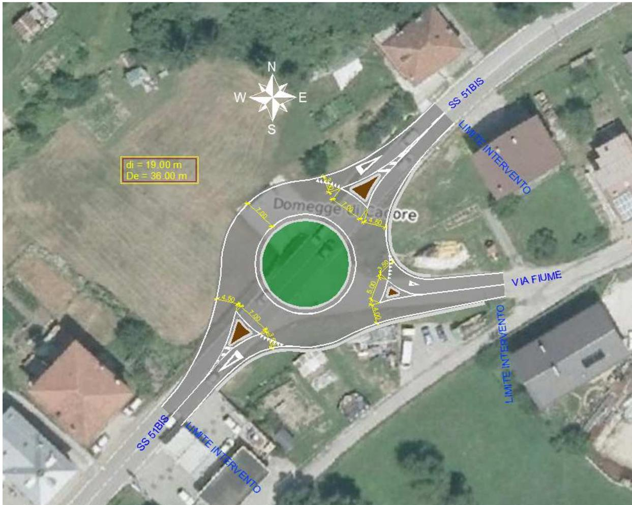
Figura 1. Inserimento su OrtoFoto della rotondina di progetto
