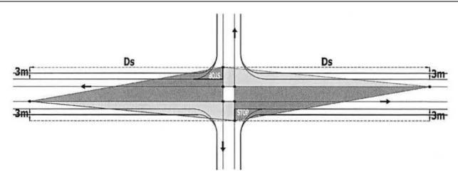
Risulta comunque importante analizzare le impronte dei triangoli di visibilità come controllo delle superfici che dovranno essere libere da ostacoli alla visibilità, con conseguente monitoraggio di tali aree nel tempo, in particolare se utilizzate in futuro per l'installazione di cartellonistiche informative ingombranti e/o per ospitare arbusti che possano raggiungere altezze impedenti la corretta visibilità degli automezzi.
