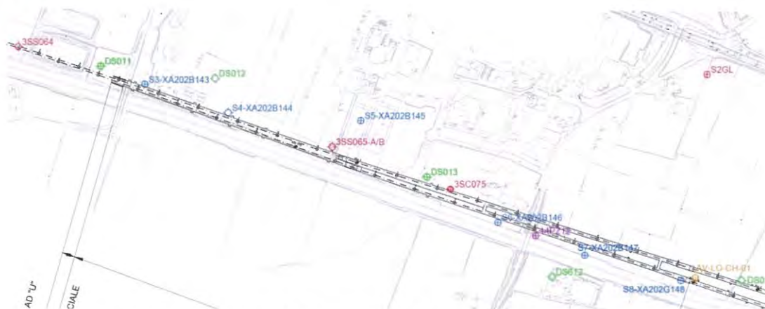
Figura 4.2- Sondaggi nella zona della galleria artificiale Lonato Ovest
