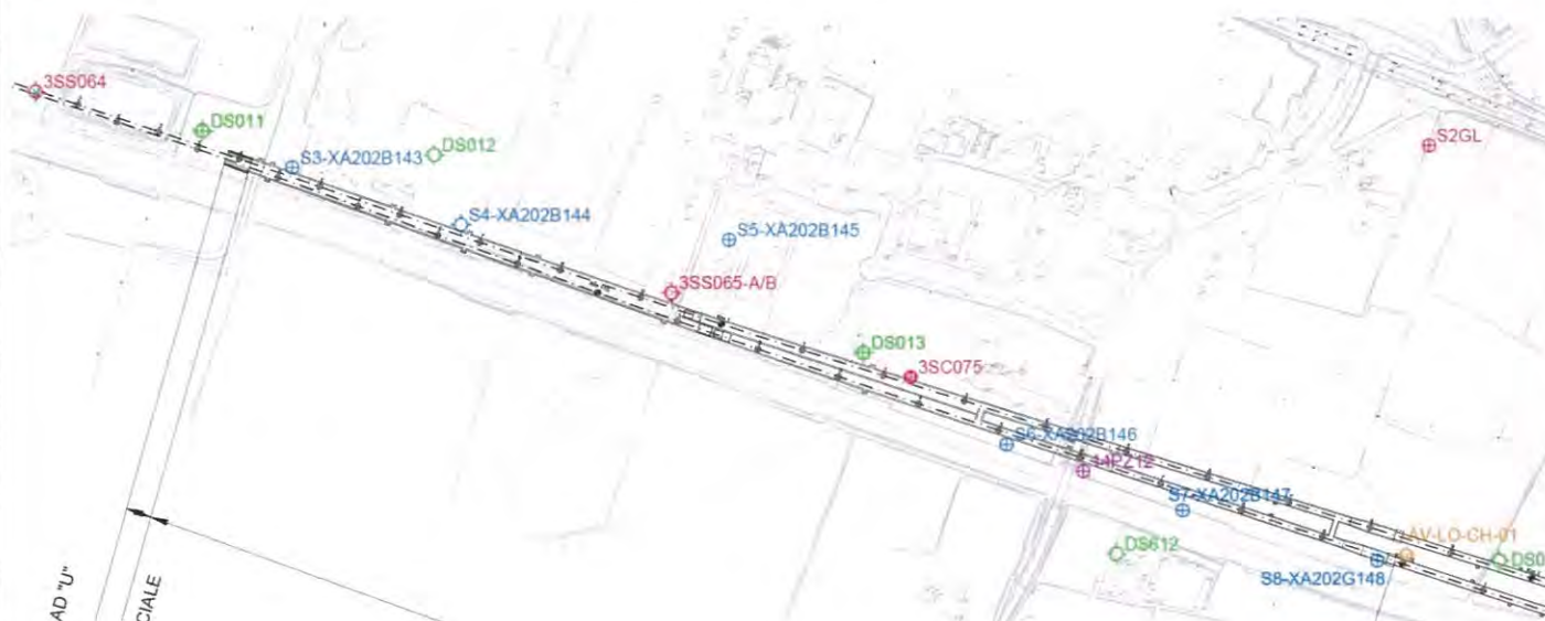
Figura 5.2- Sondaggi nella zona della galleria artificiale Lonato Ovest
