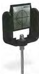
Figura 7.1 – Esempio di target topografico riflettente su supporto in plastica.
