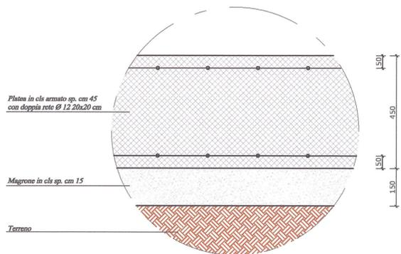
SEZIONE PLATEA FONDAZIONE UNITA' CENTRALI DI LAVAGGIO Scala 1:10
