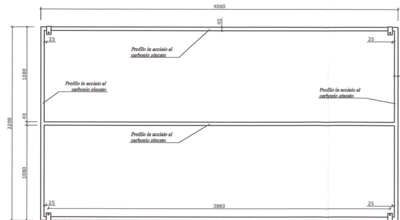
PIANTA della STRTTURA COPERTURA della TETTOIA Scala 1:20
