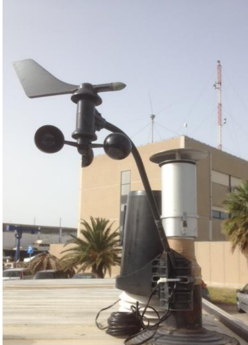
Foto 2: Centralina meteo fissa
