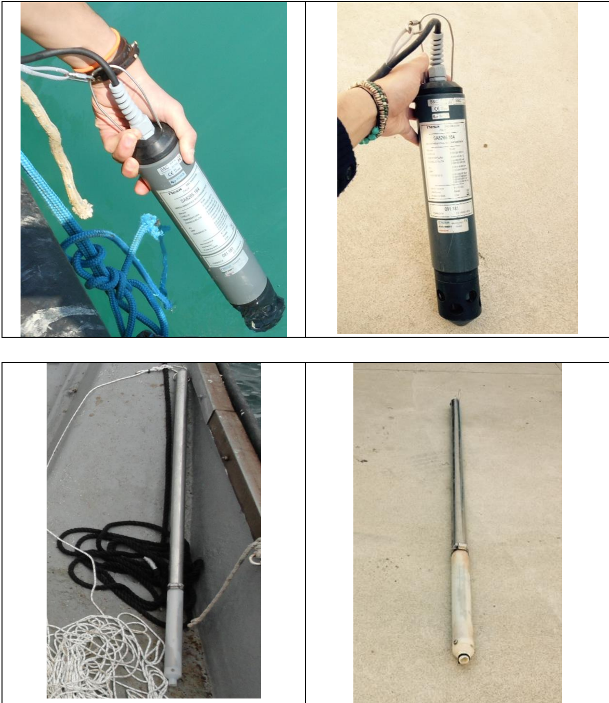
Foto 5: Sonda multiparametrica NESA e Bomb sampler utilizzato per il campionamento delle acque
