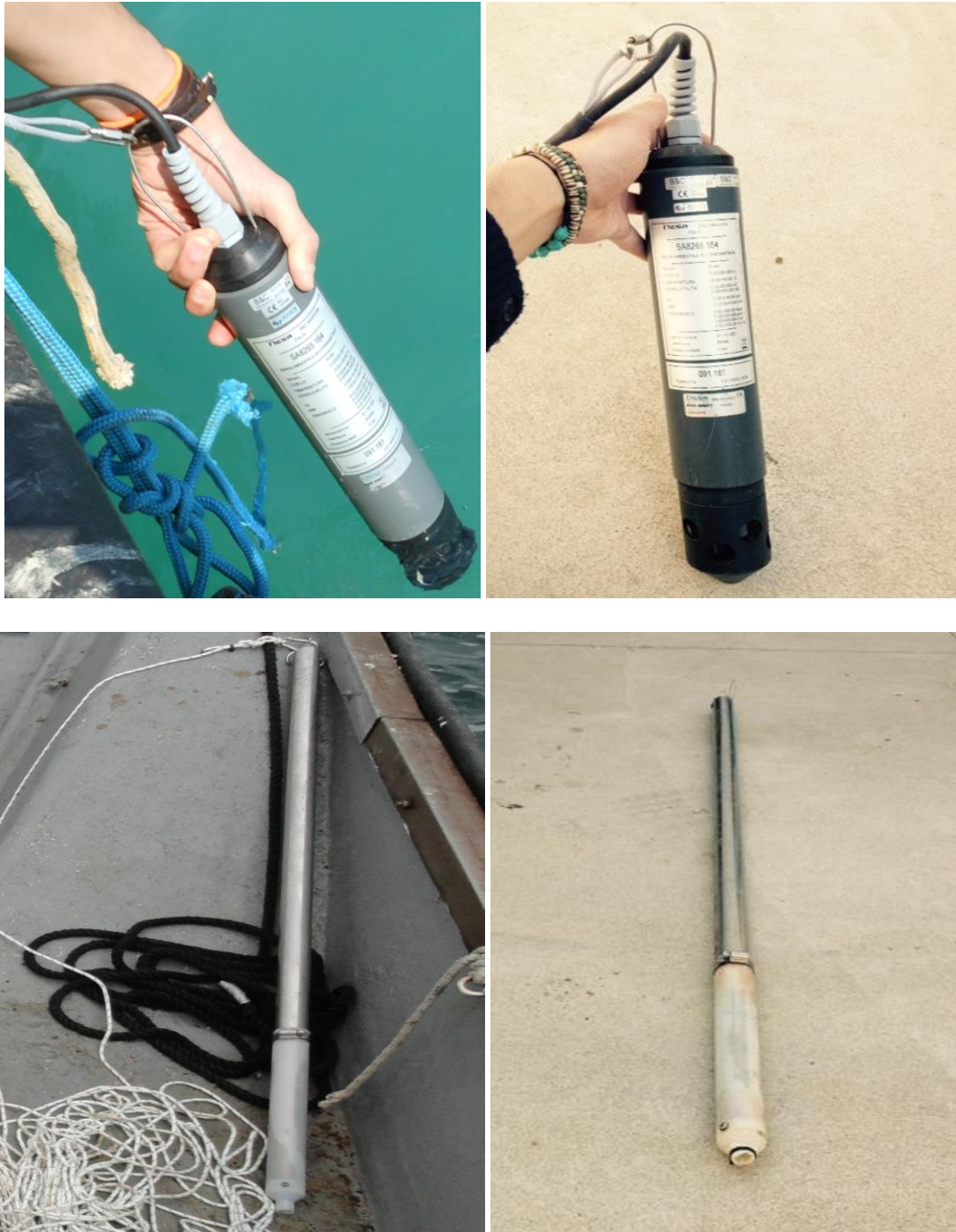
Foto 5: Sonda multiparametrica NESA e Bomb sampler utilizzato per il campionamento delle acque
