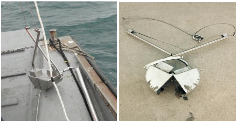
Foto 6. Benna di Van Veen utilizzata per il campionamento dei sedimenti
