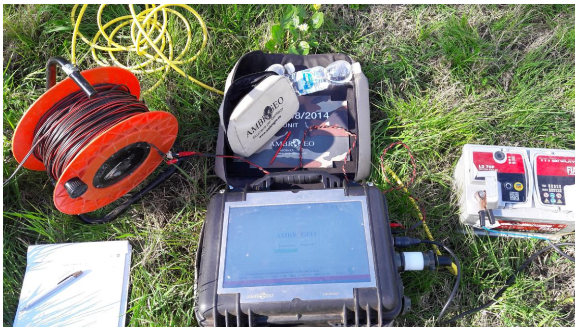
Figura 1: Sismografo digitale a 24 bit.
