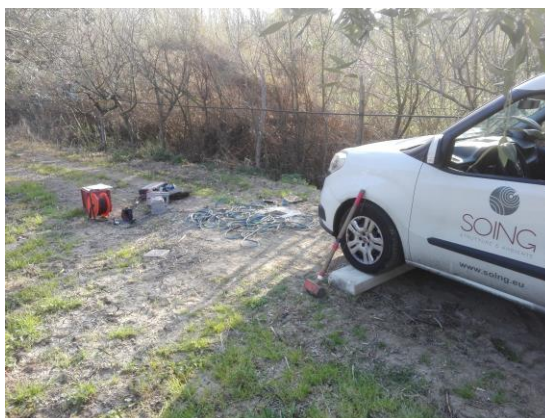
Figura 2 : configurazione standard per le indagini DHT
