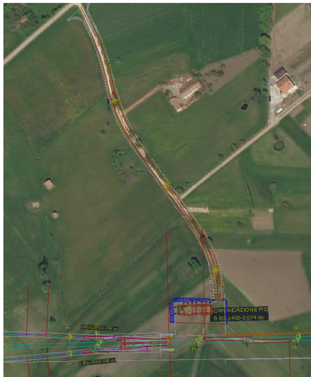
Figura 2 – Hirpinia- Configurazione planimetrica dell'intersezione NV02
