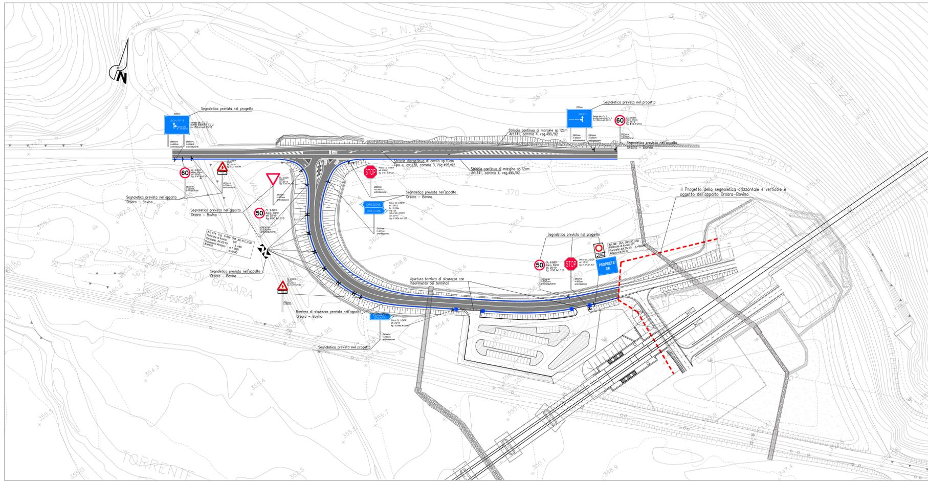
La planimetria della segnaletica in progetto è una integrazione rispetto a quanto presente e realizzata nell'appalto dell'Orsara - Bovino. In particolare la segnaletica orizzontale sarà realizzata nell'appalto Bovino - Orsara, la segnaletica verticale sarà in parte realizzata nel precedente appalto e in parte in quella in oggetto. Nella planimetria sono evidenziati su ogni cartello le fasi progettuali.
