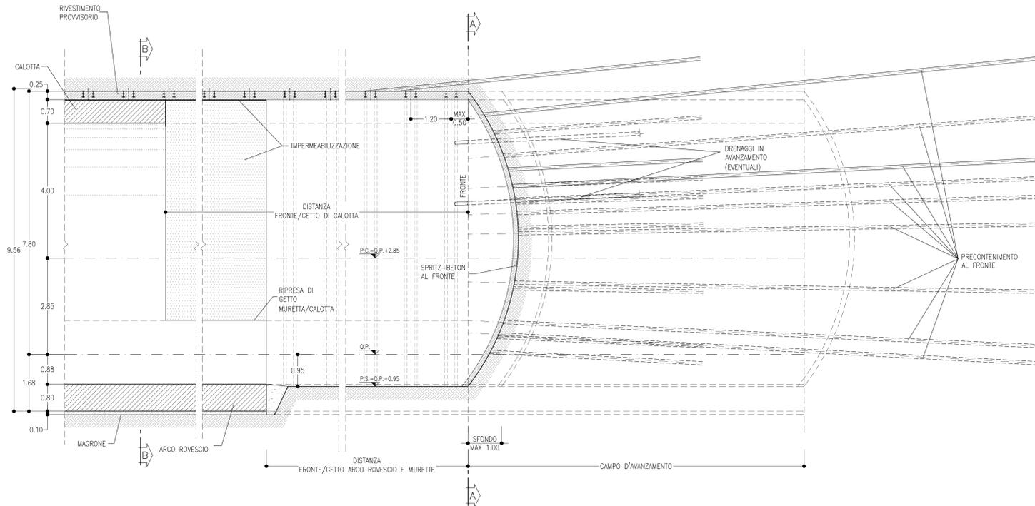
**FINESTRA COSTRUTTIVA – SEZIONE TIPO B2**
