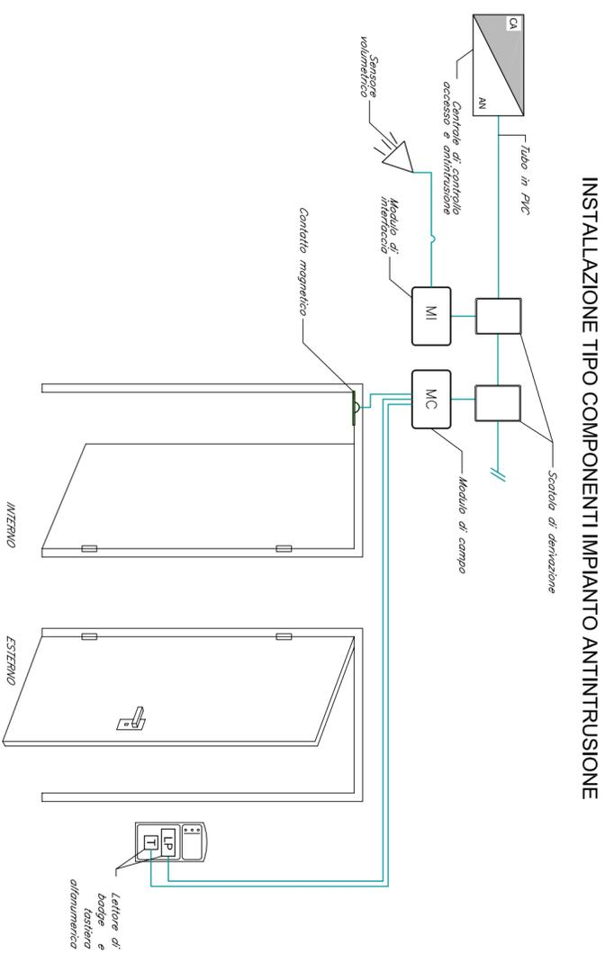
INSTALLAZIONE TIPO COMPONENTI IMPIANTO ANTINTRUSIONE
