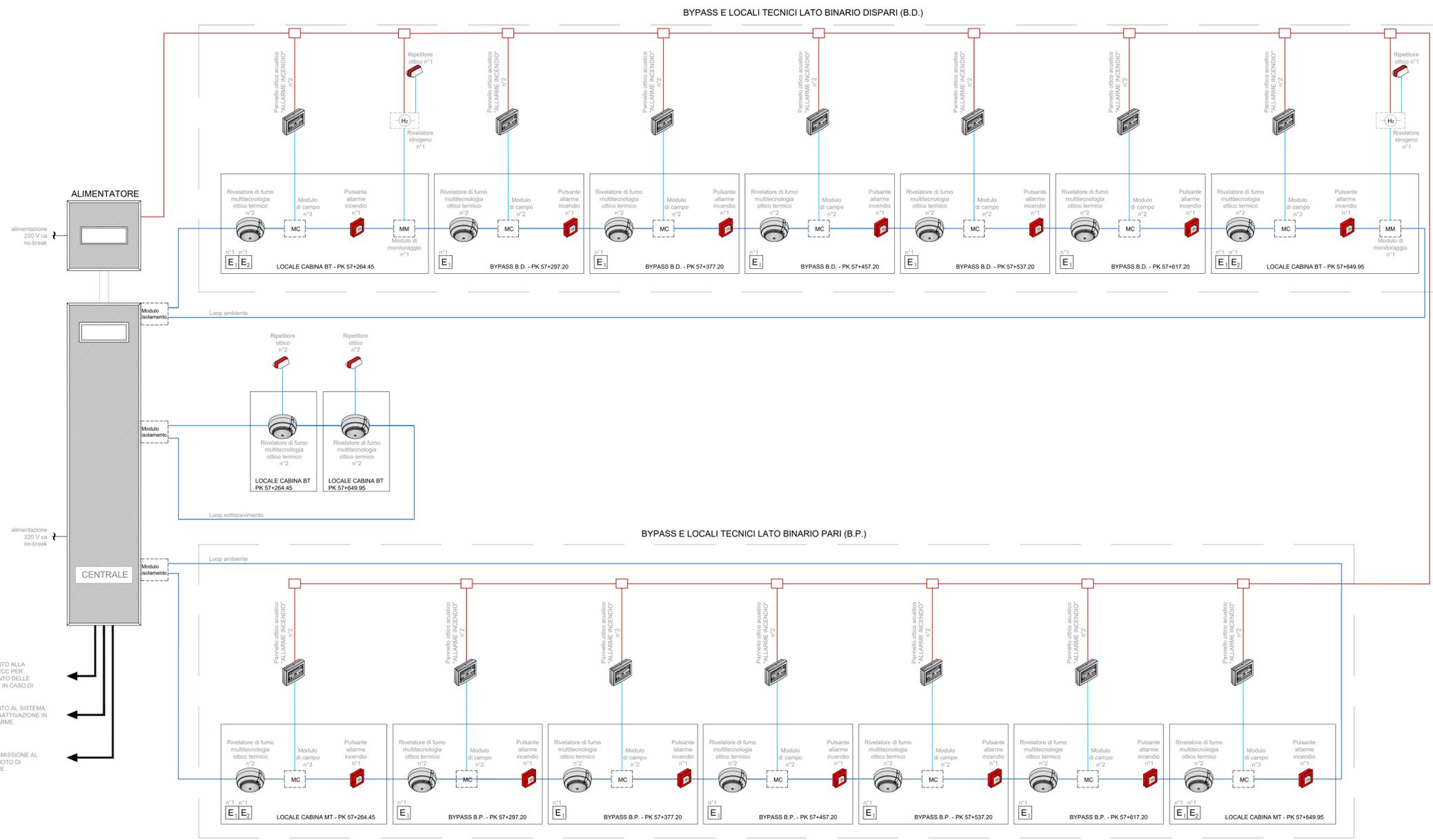
COLLEGAMENTO ALLA CENTRALE TVCC PER INDIRIZZAMENTO DELLE TELECAMERE IN CASO DI ALLARME
